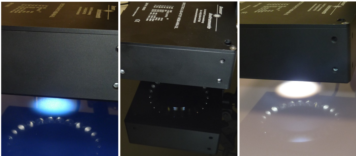
Medición del color en las placas metálicas inmediatamente después del proceso de recubrimiento con el SPECTRO-3-28-45°/0°-MSM-ANA-DL
